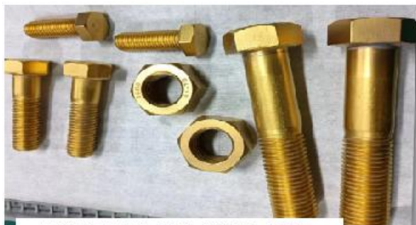
通过镀膜方式提升表面耐磨性 HV2500 3200
